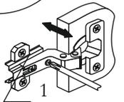
Регулировка створки по глубине
