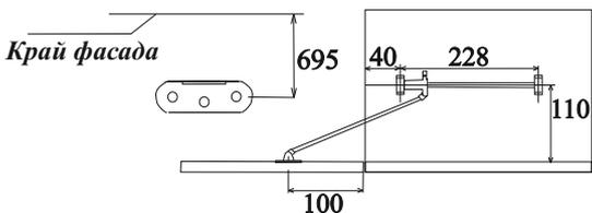
При креплении кронштейна барного к перегородке 13 использовать шурупы 4x25, для крепления к фасаду 16 - шурупы 4x16.
